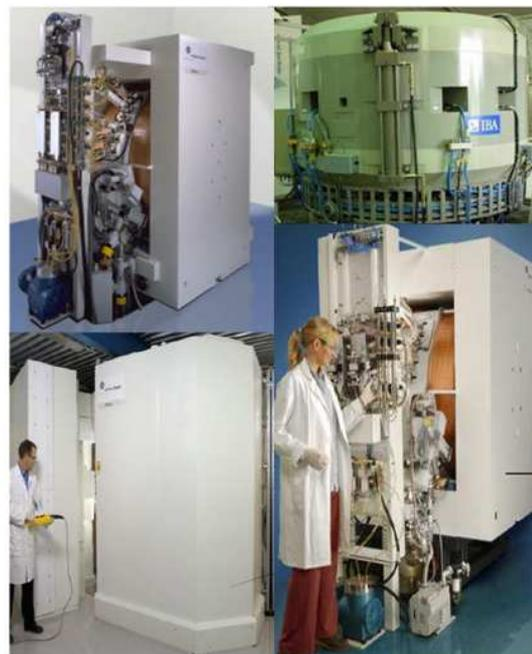
Fig. 12 Tipos de Ciclotrones; arriba izquierda tipo vertical, arriba derecha tipo horizontal, abajo izquierda tipo blindada, abajo derecha tipo vertical sin blindar
