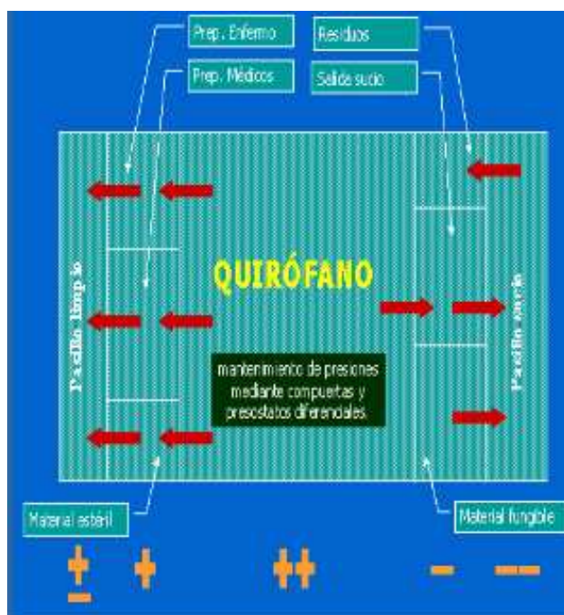
Fig. 03 Presión positiva en el quirófano
