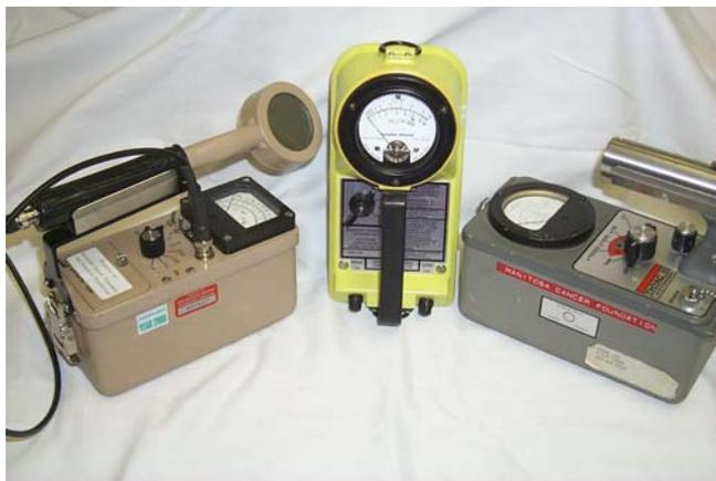
Fig. 6 Algunos Tipos de Detectores de Radiación
